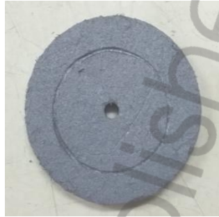
Gambar 23. Kampas Rem tromol Berbahan Baku Cangkang, Serat Buah Sawit dengan Perekat Poliuretan
